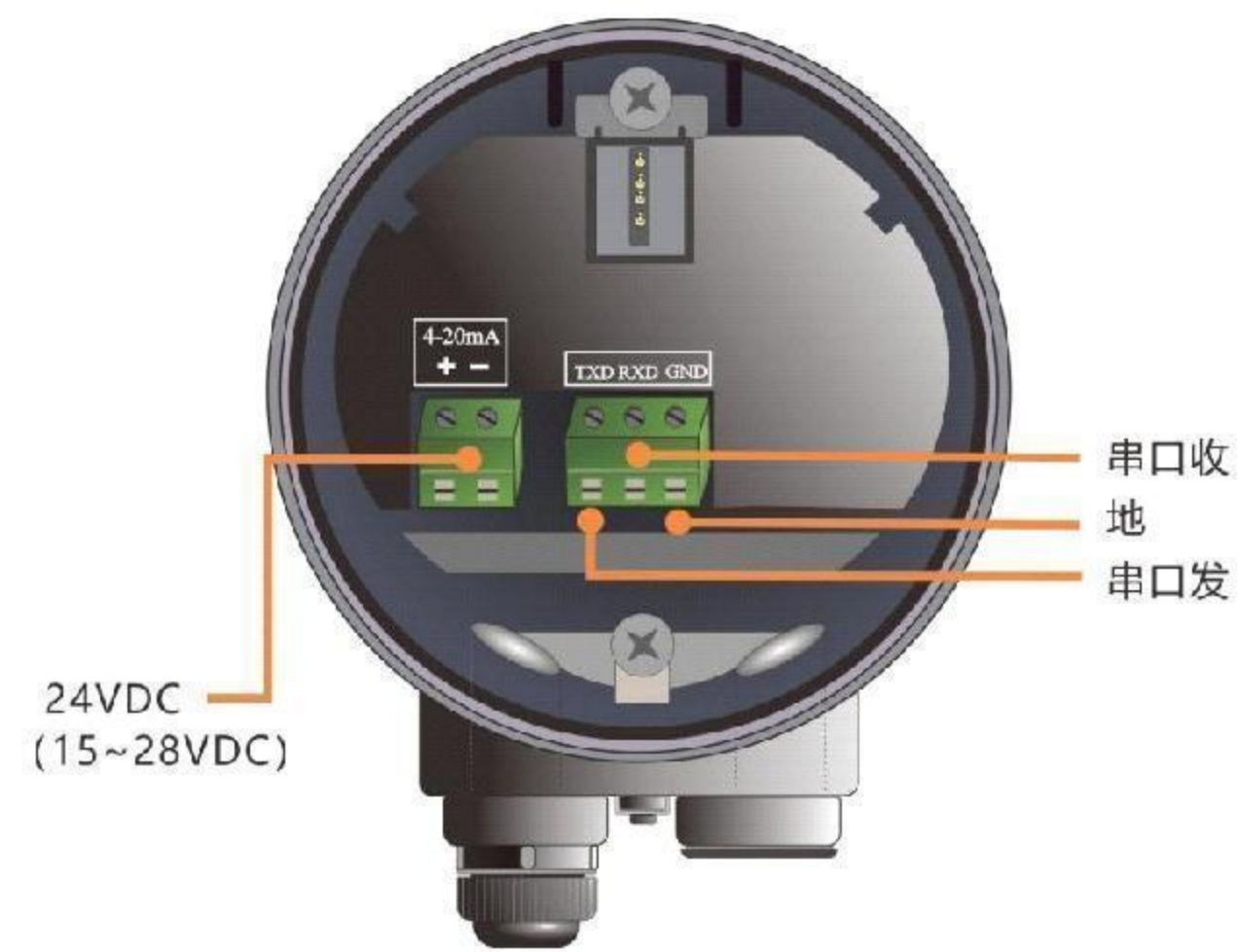
图9-2 两线制产品接线图
